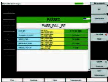
Используя Master Software Tools можно создать и загрузить пользовательские установки режима «Прошел/Не прошел» стационарного WiMAX Pass/Fail.
